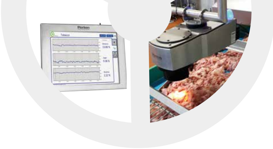
Abb. 3: At-line Display mit Trendanzeige und Installationsbeispiel (DA 7440)
