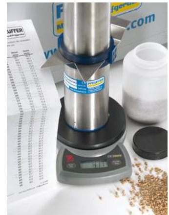
Chondrometer wiegen und entsprechendes Hektolitergewicht in der Tabelle ablesen
