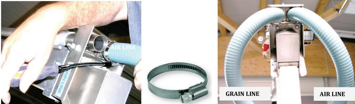
Abbildung 33: Anschluss Schläuche Entnahmespeer am Teleskoparm
