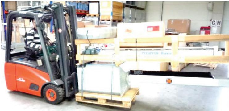
Abbildung 5: Transport mit Gabelstapler – Standardverpackung
