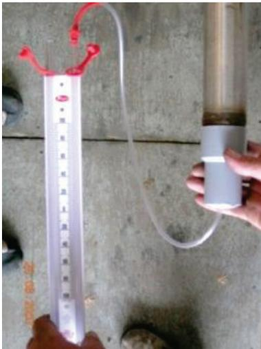
Abbildung 43: U-Rohr Manometer
